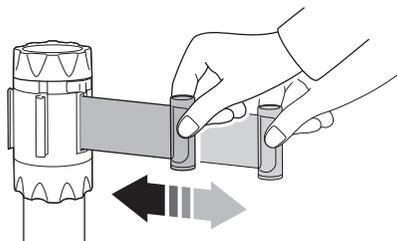
※巻き取り速度が速い場合は、セーフティーロック機構が作動し、ベルトの巻き取りを停止します。
