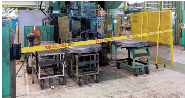
加工現場への立入規制【危険立入禁止】
