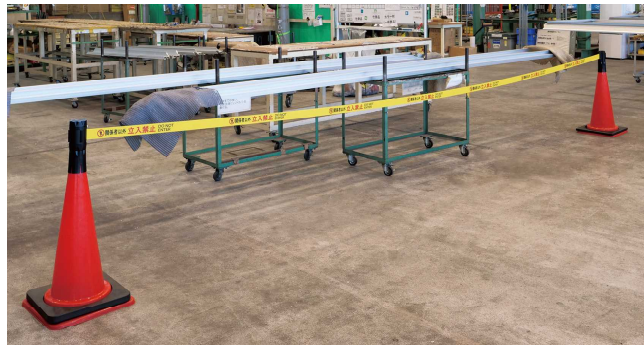
作業現場への立入規制【関係者以外立入禁止】
