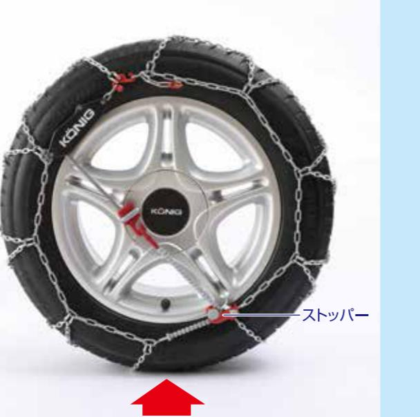
赤色ストッパーをタイヤ接地面近くにして車を停止します。
