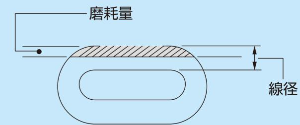
使用後にタイヤチェーンの破損・摩耗の程度を確認してください。タイヤチェーンの破損や割れがあったり、チェーンの線径の摩耗が50%を超えている時はタイヤチェーンが切れる恐れがありますので使用しないでください。
