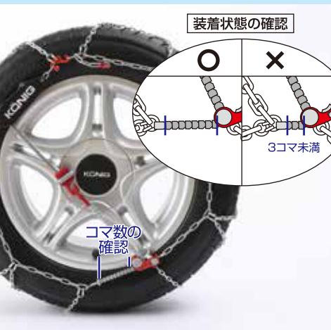
ゆっくりと300m程度走行後、一旦車を停車させ左右のタイヤチェーンの装着状態を確認します。ビーズワイヤーのつけね部分から赤色ストッパーまでのコマ数を確認して下さい。
