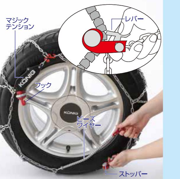
マジックテンションのフックとビーズワイヤーのリングを外し、赤色ストッパーのレバーを押しながら、ストッパーの切れこみから灰色のビーズワイヤーを外します。
