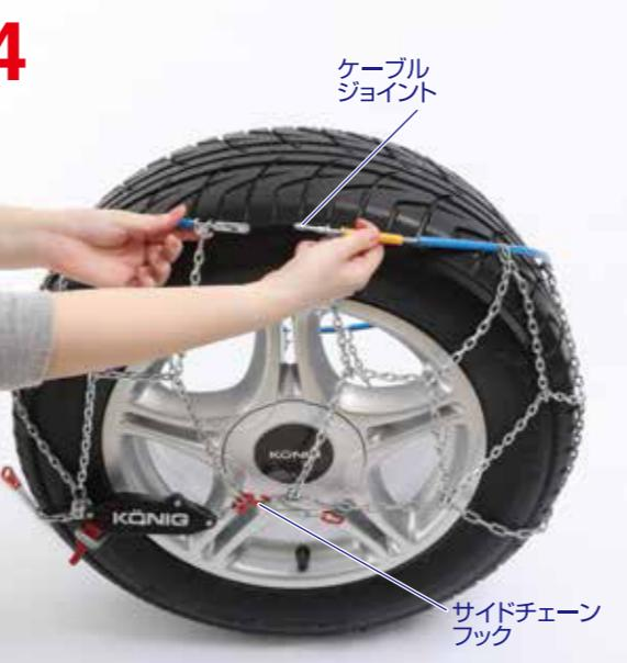
ケーブルジョイントとサイドチェーンフックを外して、地面に置きます。
