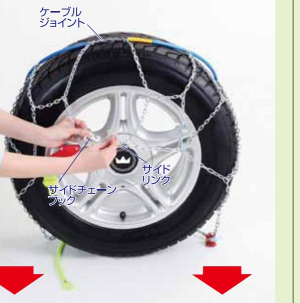
チェーンをタイヤの手前までずらしながらひっぱり、銀色のサイドチェーンフックとケーブルジョイントを外し、チェーンを地面に置きます。
