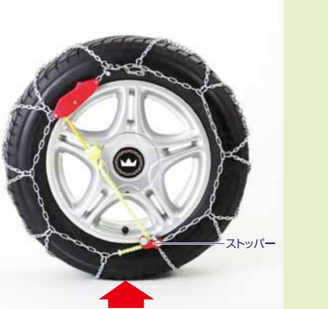
赤色ストッパーをタイヤ接地面近くにして車を停止します。
