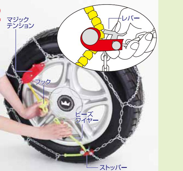
マジックテンションのフックとビーズワイヤーのリングを取り外し、赤色ストッパーのレバーを押しながら、黄色のビーズワイヤーを外します。
