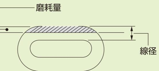
使用後、もしくは走行中に連続した空転や、急発進・急ブレーキ等が行われた際は、タイヤチェーンの破損・摩耗の程度を確認してください。タイヤチェーンの破損や割れがあったり、線径の摩耗が50%を超えている時はタイヤチェーンが切れる恐れがありますので使用しないでください。
