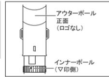
3 右図の位置でアウターポールを矢印の方向に回し、固定します
