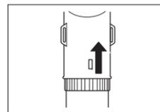
**!** ●アウターポールが抜けた場合、アウターポールの正面とインナーポールの▽印側の向きを合わせて差し込んでください。向きを合わせずに差し込むと破損の原因になります。
