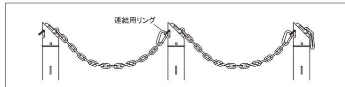
連結用リングにプラチェーンの接続金具を固定します
