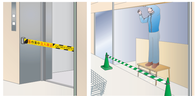
昇降機のメンテナンス (作業中立入禁止)
