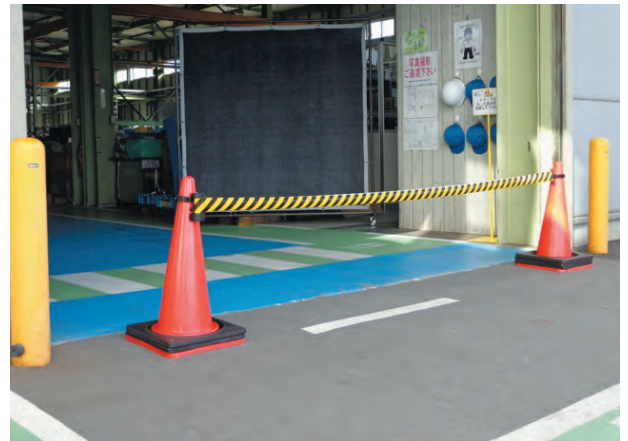
フォークリフト、トラック等 車輛の一時的な進入禁止に (工場内の作業者の安全を確保)
