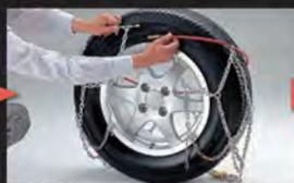
ケーブルの両端をタイヤの手前に引き上げ、フックをかけます。
